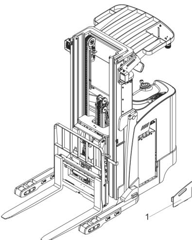
图 26 电池更换示意图
