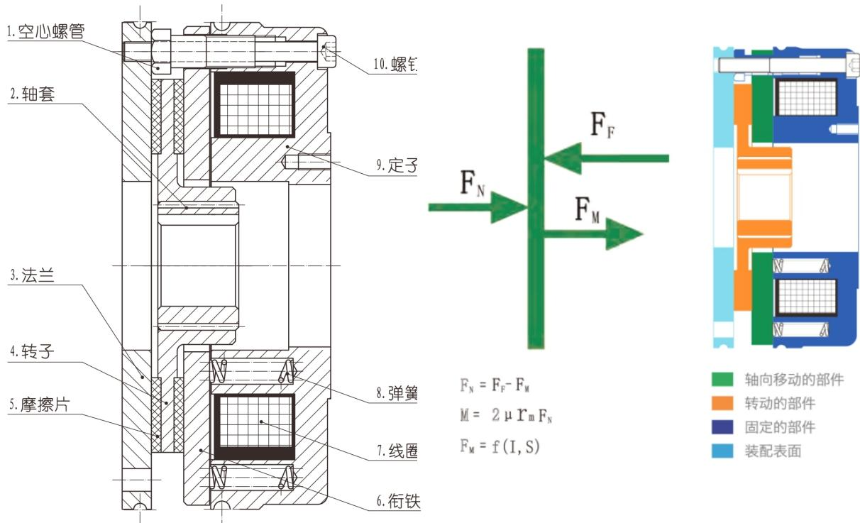
图 16 制动原理图
