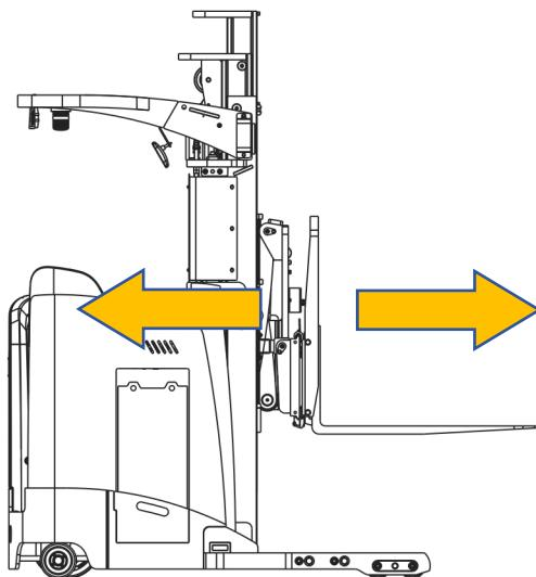
图 19 门架前移后移示意图
