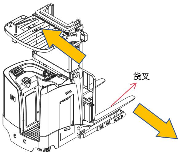
图 20 货叉侧移示意图
